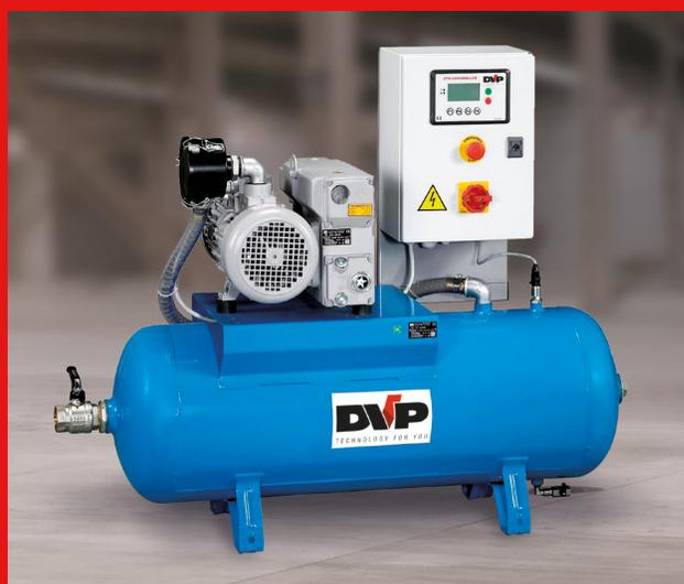
**SISTEMI INDUSTRIALI:** le centrali di produzione vuoto sono costruite in base al numero di pompe installate. Sono dotate di quadro di comando che controlla la pressione all'interno del serbatoio e pilota l'avvio delle pompe. I quadri includono anche il conta-ore e il dispositivo di bilanciamento dell'usura delle pompe.
