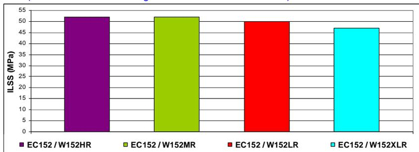
I laminati sono stati ottenuti stratificando manualmente un tessuto di vetro da 300g/m<sup>2</sup> (tipo raso da 8) con i vari sistemi fino ad ottenere uno spessore di 5 mm. I provini sono stati ricavati dal manufatto secondo la normativa ASTM D2344 e stabilizzati per 16 h a 50°C prima della prova.
